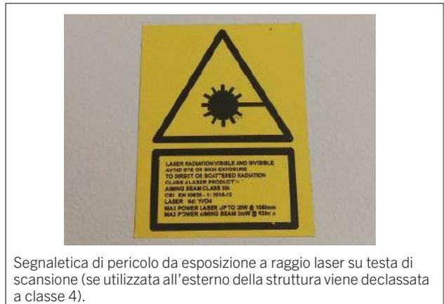
Segnaletica di pericolo da esposizione a raggio laser su testa di scansione (se utilizzata all'esterno della struttura viene declassata a classe 4).
