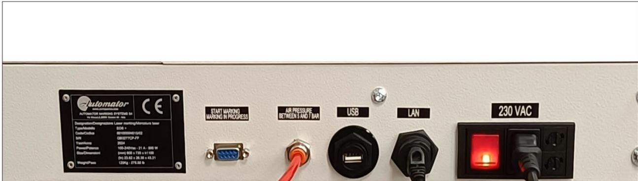
1. Connettore usb tipo A per connessione scheda di controllo per aggiornamento
