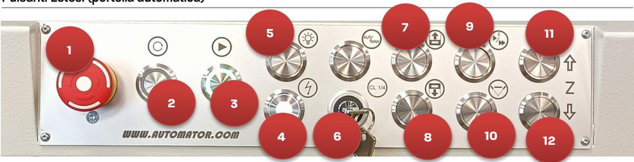
**1. EMERGENZA** – Pulsante rosso con funzione di arresto di emergenza del sistema laser. Quando viene attivato, spegne la sorgente e gli assi lasciando alimentati gli ausiliari. Per ripristinare il sistema, sganciare il fungo ruotandolo e premere il pulsante di “RESET” blu.
